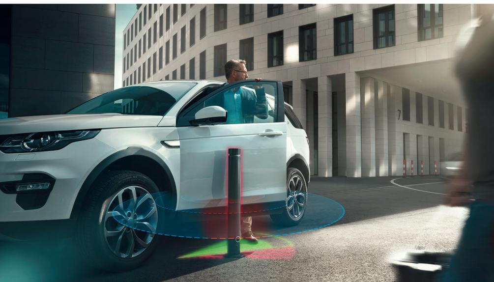
**Bild 2: Seitentürantrieb mit Radar-Kollisionsschutz.** © Brose
